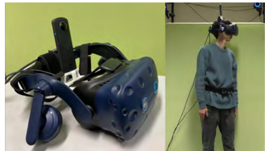
図6 360度カメラをHMDに装着して実映像を体験可能とするシステム(左)。実際に使用している様子(右)。
